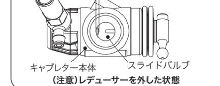
(注意) アイドル調整バルブ、及びメータリングニードルは工場出荷時に基準位置に調整済みですが、使用される燃料や気象条件などにより再調整が必要な場合があります。基準位置で運転されてみて良い結果が得られない場合は「キャプター調整」の項を参考に調整してください。
